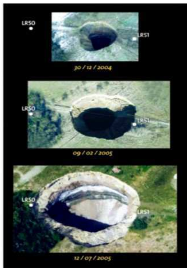
Figura 2.5 – Evolução de uma cratera provocada pela exploração de sal-gema, Nacy-França.
